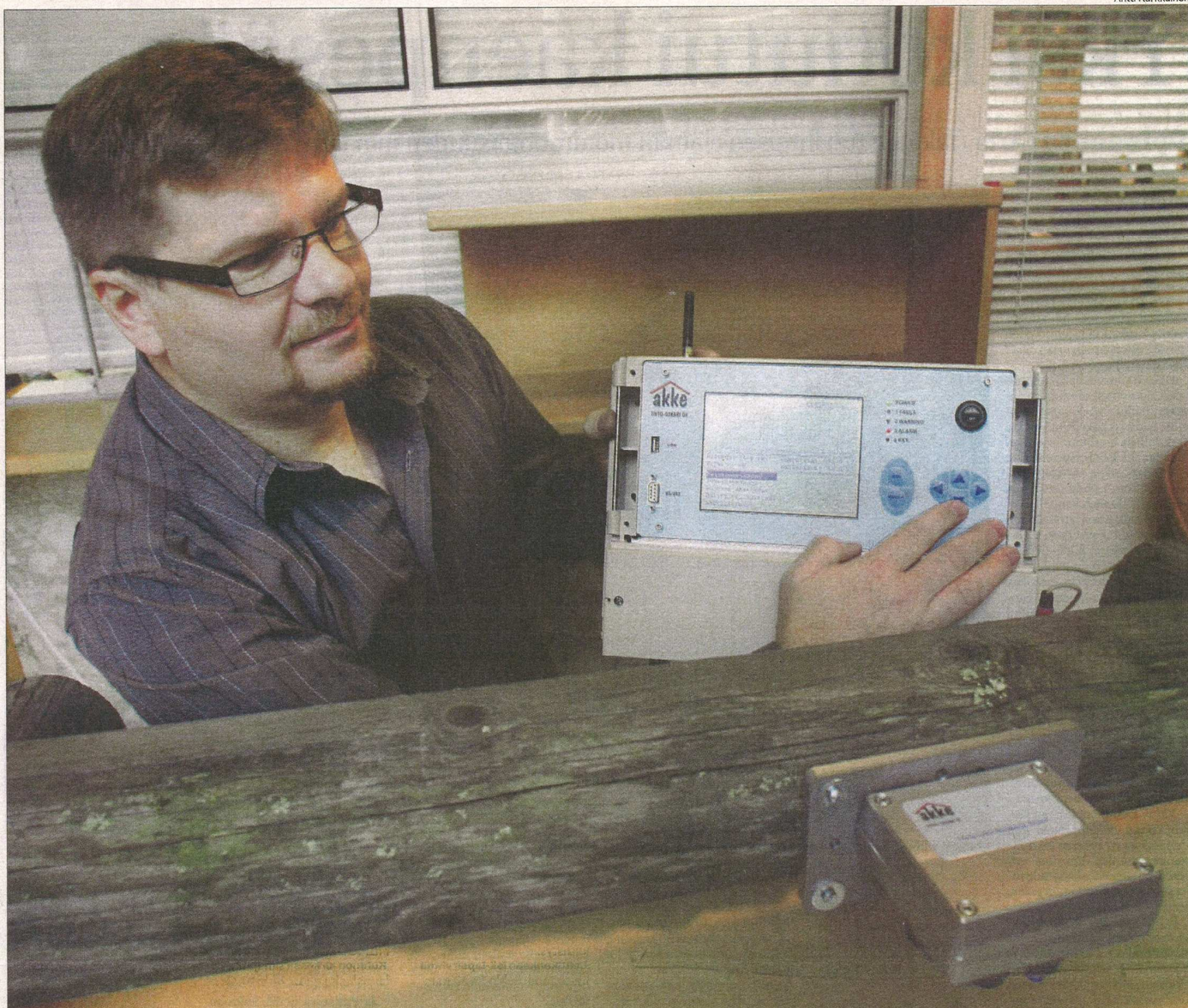
- Akke-järjestelmä muodostuu noin kolme kiloa painavasta keskusyksiköstä ja puolisen kiloa painavista antureista, Taito Heikkinen kertoo.
